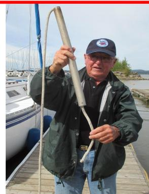
Insérez complètement le tuyau de métal dans le tube de caoutchouc et passez le cordage non-flottant à l'intérieur.
