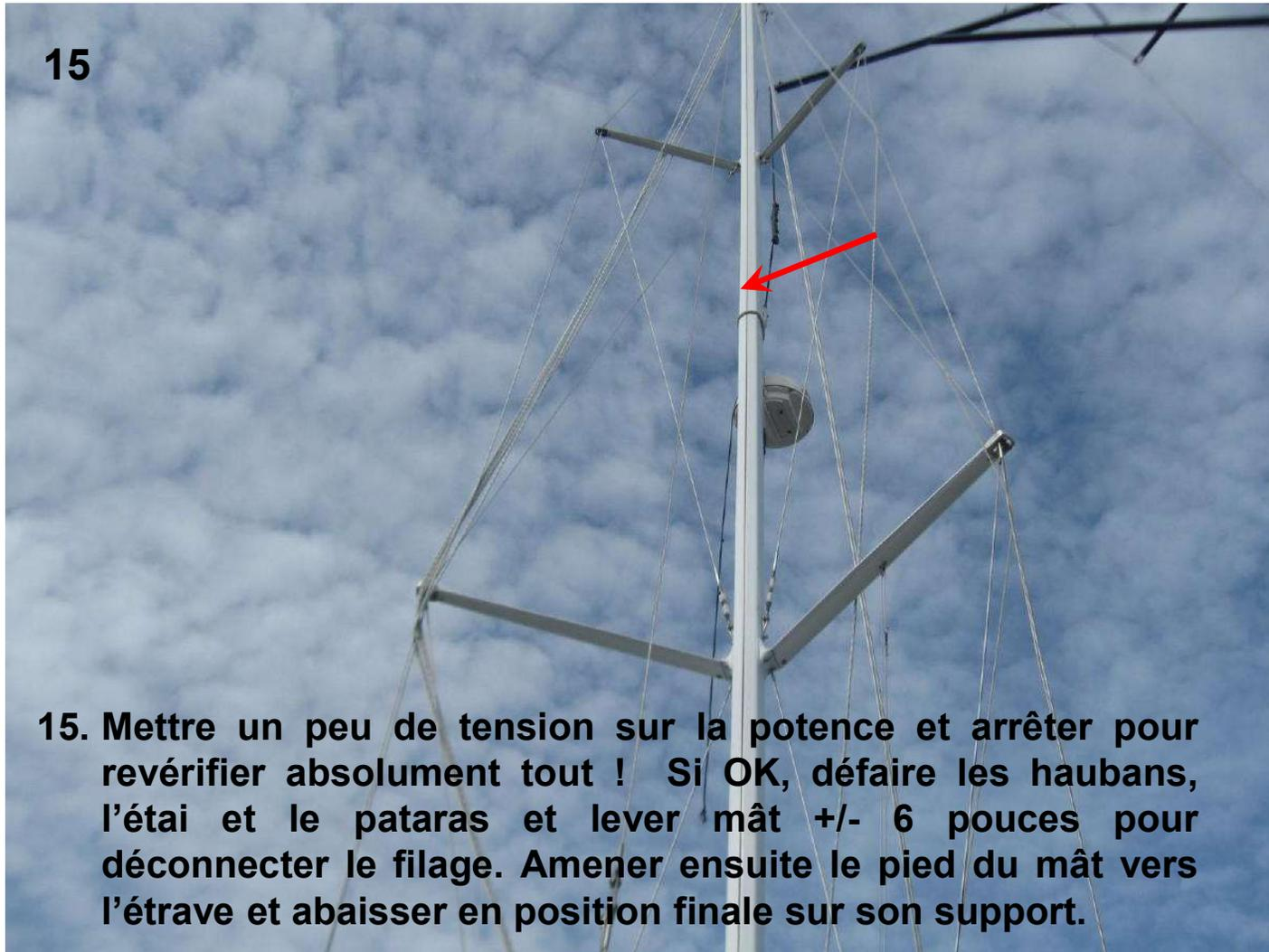
**15. Mettre un peu de tension sur la potence et arrêter pour revérifier absolument tout ! Si OK, défaire les haubans, l'étai et le pataras et lever mât +/- 6 pouces pour déconnecter le filage. Amener ensuite le pied du mât vers l'étrave et abaisser en position finale sur son support.**
