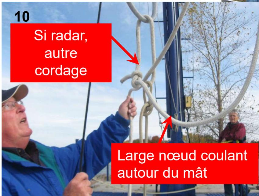
10. Monter la potence lentement en gardant le cordage juste assez serré pour installer le crochet au dessus du feu de hune et garder le large nœud coulant ouvert.
